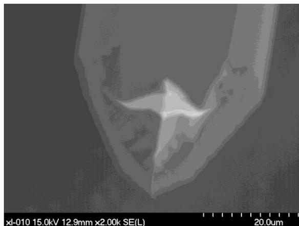
图 2-4 针尖的 SEM 图像
